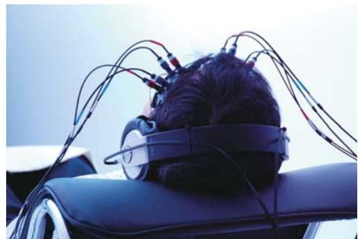
写真3 プローブホルダーとプローブ
